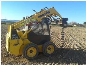
Para su montaje se realizarán sobre el terreno perforaciones mediante ahoyador de 1 mt aprox. con un diámetro de unos 20-40 cms dependiendo del diámetro del tubo.
